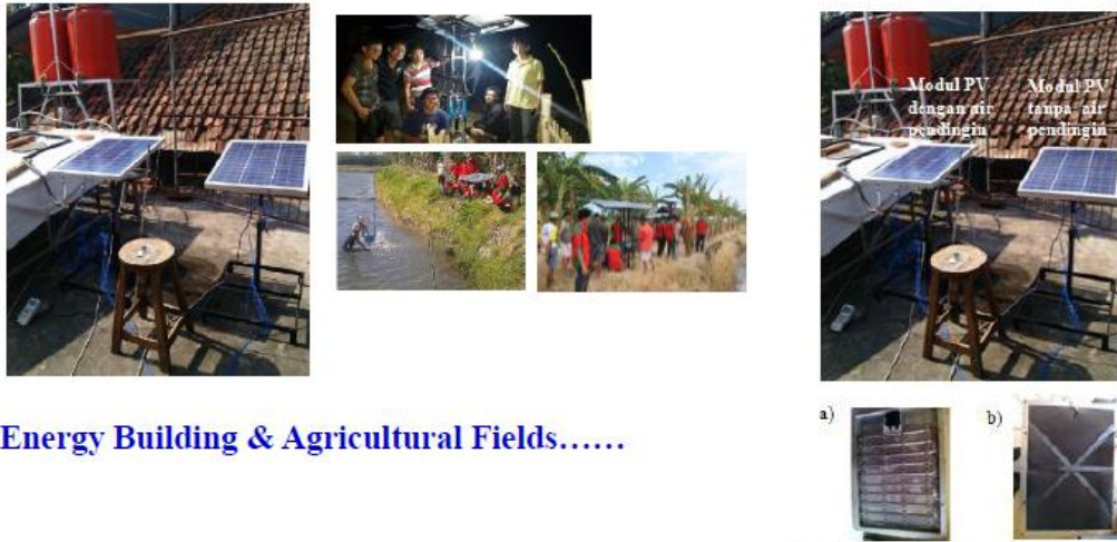
Gambar 1. Alat uji modul PV dengan dan tanpa air pendingin a) pipa air pendingin b) permukaan bawah dengan insulasi
